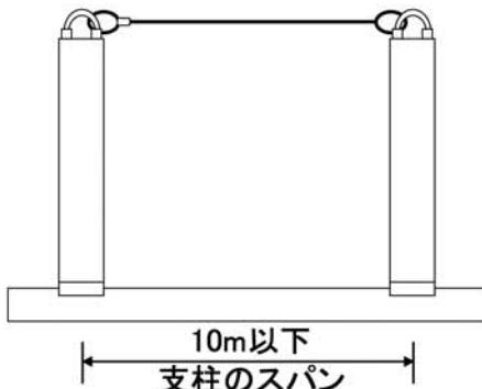
Lは支柱のスパン(m)、Hは作業床と衝突のおそれのある床面または機械設備などの垂直距離(m)
