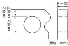
⚠ 敷鉄板の穴寸法、厚みは図の範囲内で使用して下さい。
