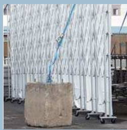
基礎ブロック
